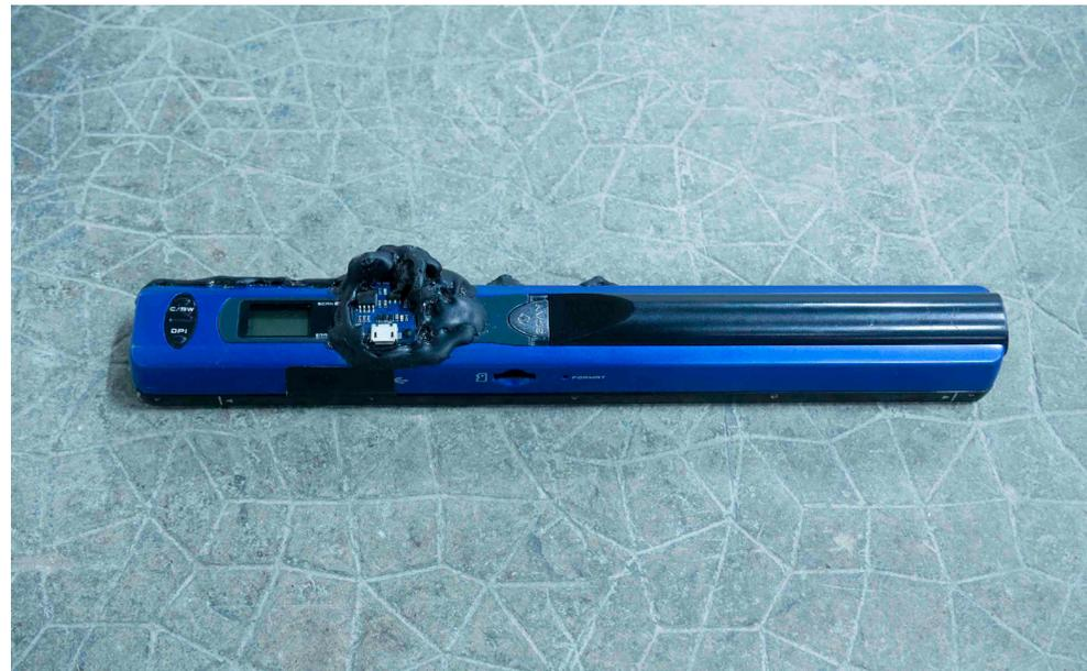
C - 2021 / Troisième prototype, sans piles et muni de deux boutons permettant de varier la vitesse de numérisation avec une seule main.
