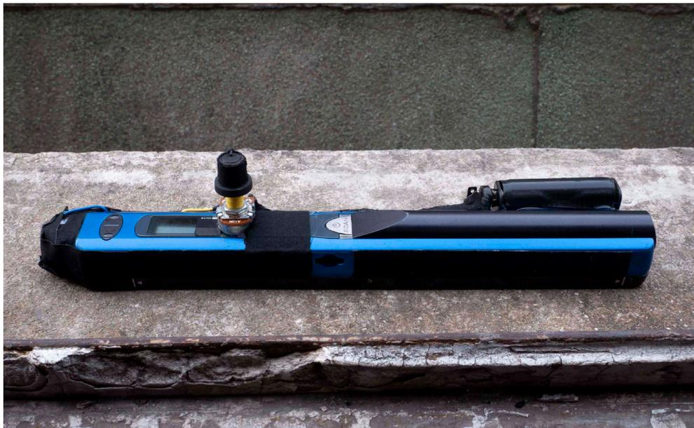
A - 2020 / Premier prototype autonome, fonctionnant à piles et avec un potentiomètre permettant de modifier la vitesse de numérisation.
